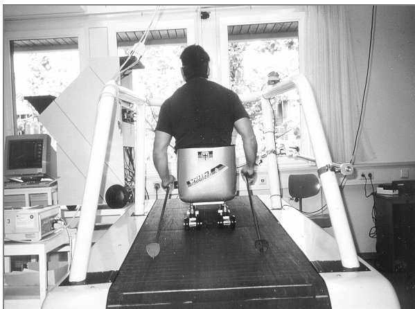
Abb. 5: Langlaufschlitten-Fahrer mit Paraplegie bei der Skischlittenergometrie auf dem Laufband
