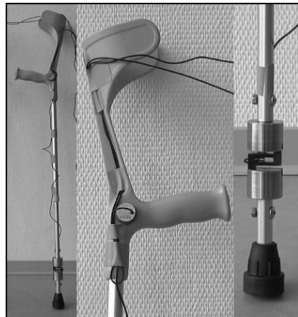
Abb. 2. Speziell angefertigte Gehstützen mit Inclinometer (Mitte) und Kraftaufnehmer (rechts).
