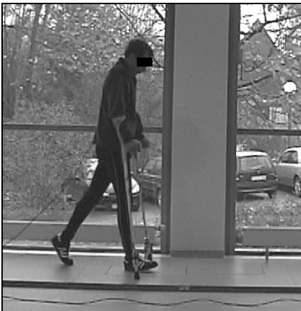
Abb. 1. Ganganalyse nach Hüft-TEP mit Teilbelastung, Gangbahn mit 2 Kistler-Kraftmessplatten und Gang mit speziellen Gehstützen (s. Abb. 2).
